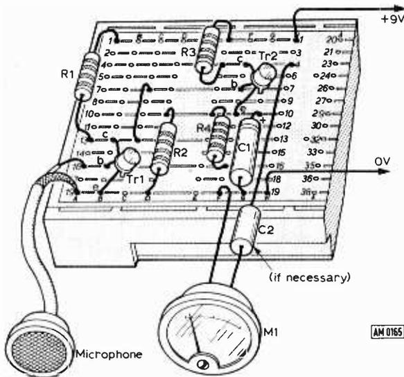
Fig. 54: Component layout for Fig. 53.
