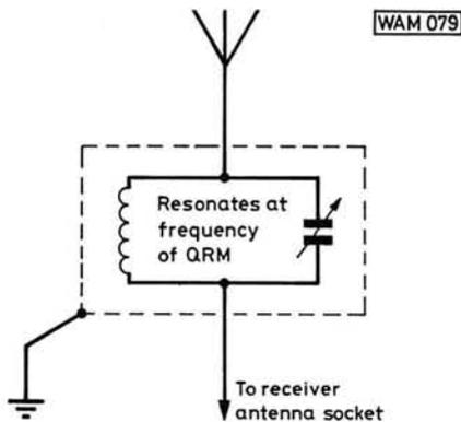
Fig. 1: Wavetrapp
