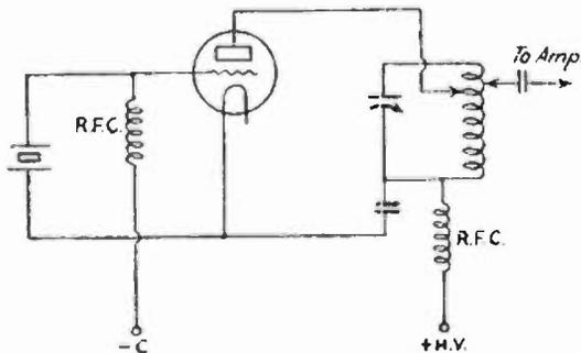
**THE POWER CRYSTAL OSCILLATOR CIRCUIT**
