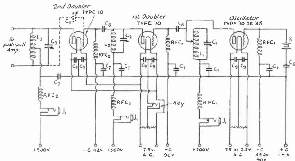
THE OSCILLATOR AND FREQUENCY-DOUBLER CIRCUIT
