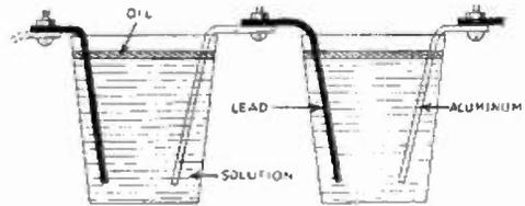
TYPICAL CHEMICAL RECTIFIER CELLS
