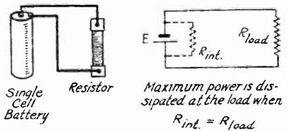
CONDITION FOR MAXIMUM POWER IN A CIRCUIT
