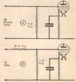
Fig. 8 .- Connections for crystal microphones.
