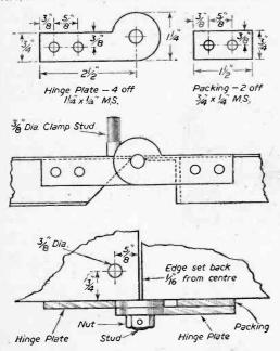
Fig. 4 .- Details of the hinge.
