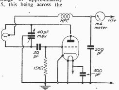
Fig. 55.—A V.H.F. test oscillator.
