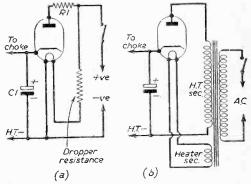
Fig. 5.—Using a valve rectifier.
