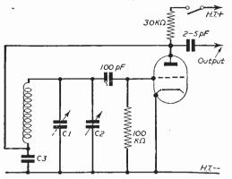
Fig. 2.—A triode oscillator circuit.
