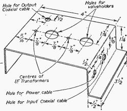
Fig. 15 .- Details of chassis.
