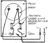
Fig. 4.-A voltmeter circuit.
