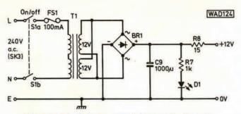
Fig. 1.2: Circuit diagram of the optional p.s.u.
