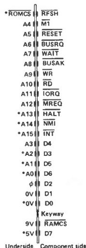
Figure 4: Edge connector wiring
