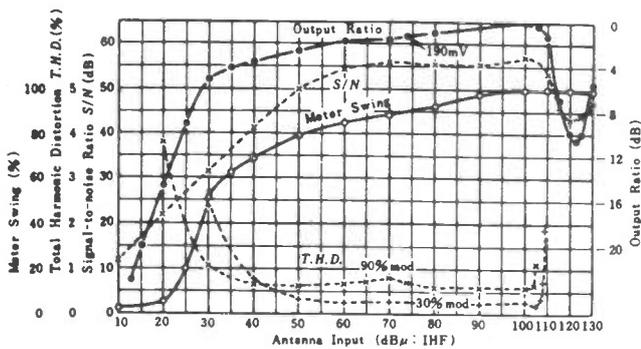
**MAXIMUM 2fi AND 3fi BEAT REJECTION RATIO VS. ANTENNA INPUT**
