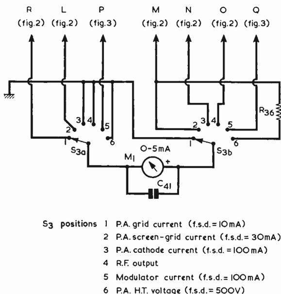
Fig. 4. Meter switching circuit
