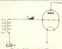
Fig. 4. Grid current rectifier.
