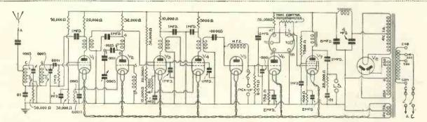
SEVEN-VALVE CIRCUIT OF THE SEVENTY-SEVEN SUPER
