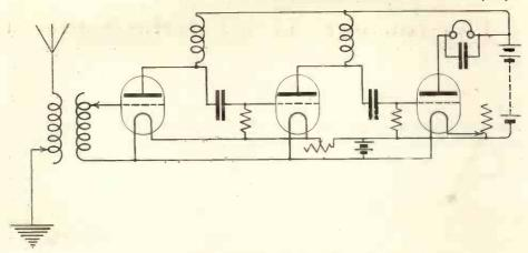
Fig. 17. Impedance Amplifier.
