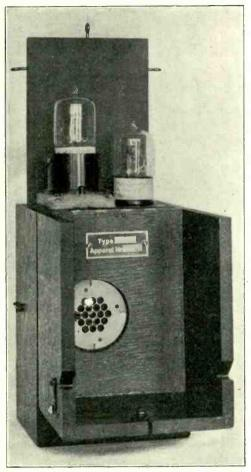
By courtesy, Gesellschaft für drahtlose Telegraphie. Fig. 5. Single valve amplifier unit with spare valve.
