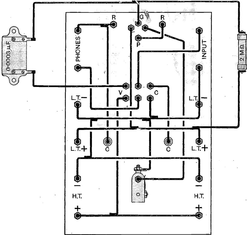
Fig. 3. The wiring diagram.
