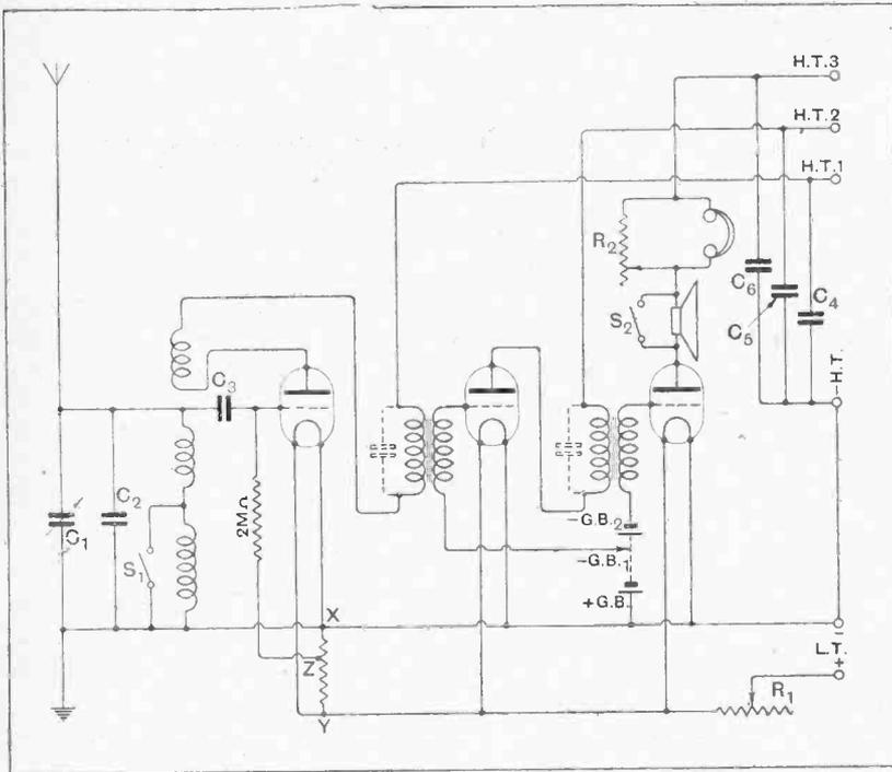
Fig. 1.—Circuit diagram.  $C_1=0.0003$  mfd.;  $C_2=0.0003$  mfd.;  $C_3=0.0003$  mfd.;  $C_4, C_5, C_6=2$  mfd.;  $R_1=15$  ohms;  $R_2=30$  ohms for 120 ohm phones.
