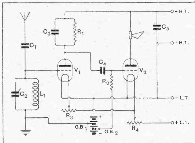
Fig. 1.—The circuit diagram.— $C_1=0.0002$  mfd.;  $C_2=0.0005$  mfd.;  $C_3=0.0001$  mfd.;  $C_4=0.001$  mfd.;  $C_5=1$  mfd.;  $R_1=1$  megohm;  $R_2=5$  megohms;  $R_3=25$  ohms;  $R_4=6$  ohms.
