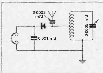
Fig. 2.—An efficient crystal circuit.
