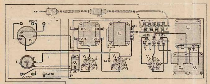
Fig. 2.—The practical wiring plan.
