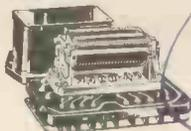
**SOLENOID OPERATED MAGNETIC RELAY.**
