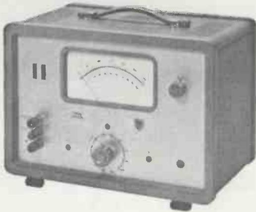
**DC Microvoltmeter, type GM 6020**
