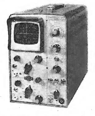
Model 227A double-beam oscilloscope from Compagnie Générale de Métro-logie.
