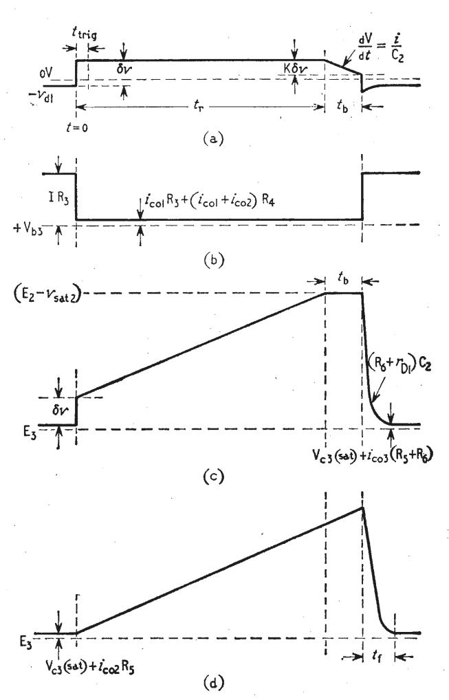
Fig. 2. Waveforms in circuit of Fig. I. At (a) base of TI ( $V_{\rm b1}$ ); (b) collector of TI ( $V_{\rm e1}$ ); (c) collector of T2 ( $V_{\rm e2}$ ); (d) voltage across  $C_1$ .
