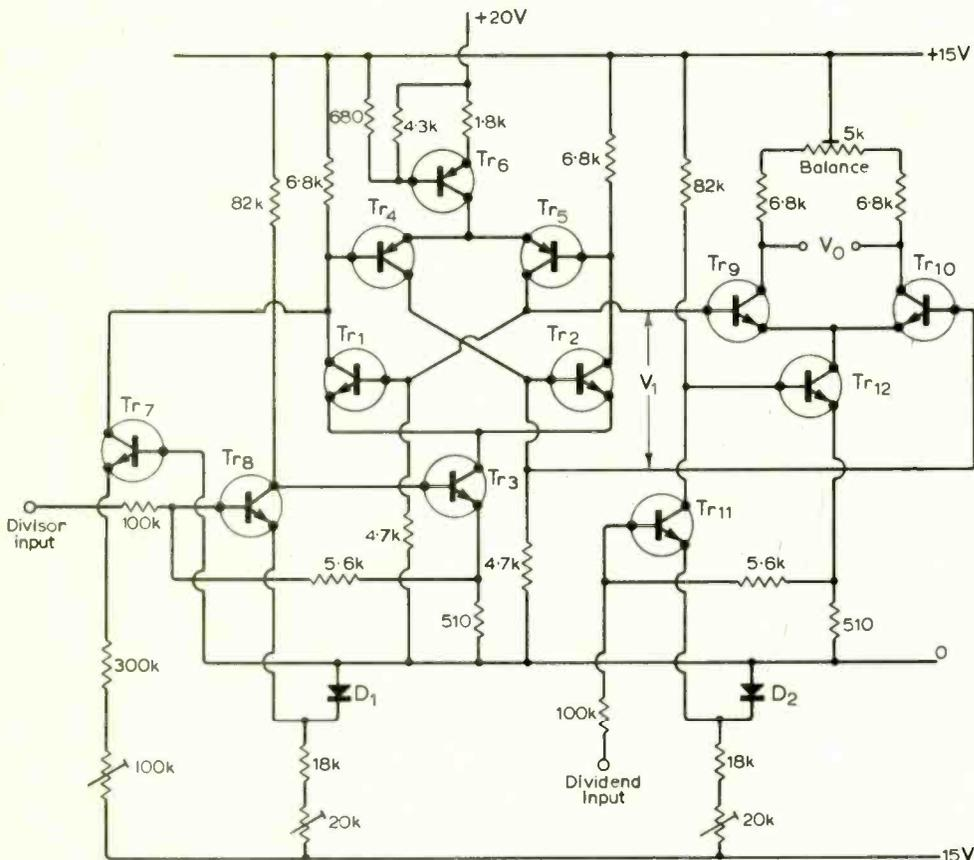
Fig. 10. An analogue divider circuit.
