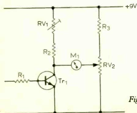
Fig. 24. The S metre circuit.
