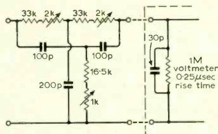
Fig. 7. Twin-T filter for 68kHz.
