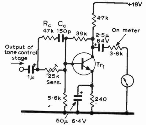
Fig. 18. VU-metering amplifier.  $Tr_1$  BC109 etc.
