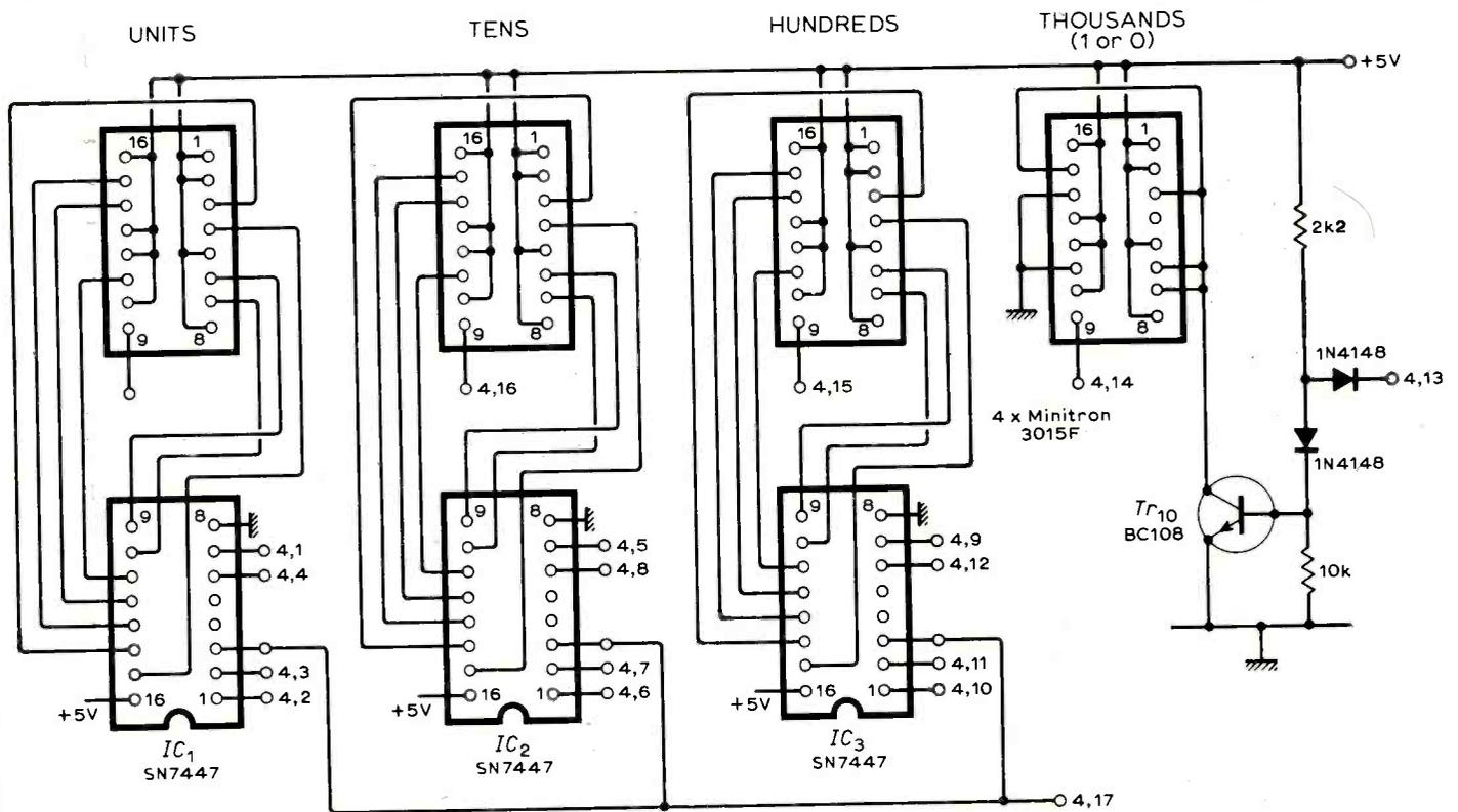
Fig. 4. Decoder/display diagram.
