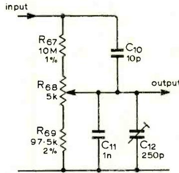
Fig. 10. Input attenuator.
