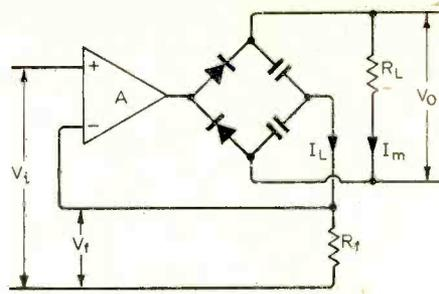
Fig. 9. Basic rectifier circuit
