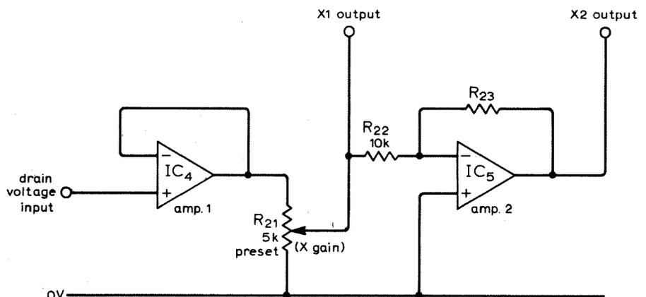
Fig. 9. X-voltage amplifier.
