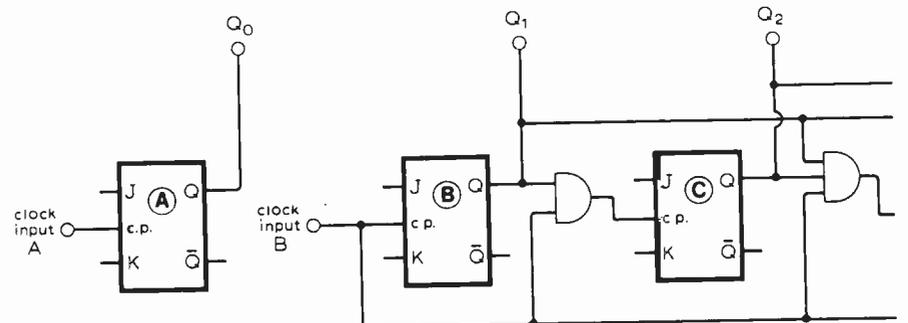
Fig. 7. Semi-synchronous format.
