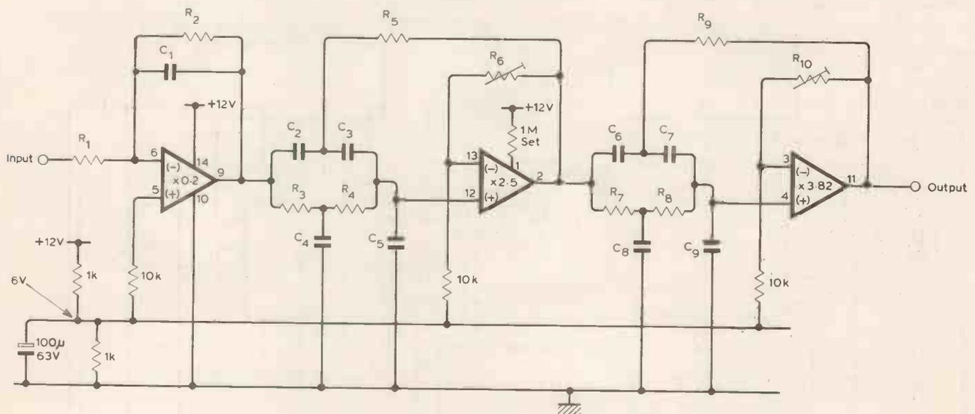
Resistors: 1 — 56k; 2 — 12k; 3, 4 — 20k; 5 — 10k; 6 — 47k pot; 7, 8 — 16k; 9 — 8k2; 10 — 100k pot. Capacitors: 1 — 10n; 2, 3, 5, 6, 7, 9 — 1n5; 4, 8 — 3n.
