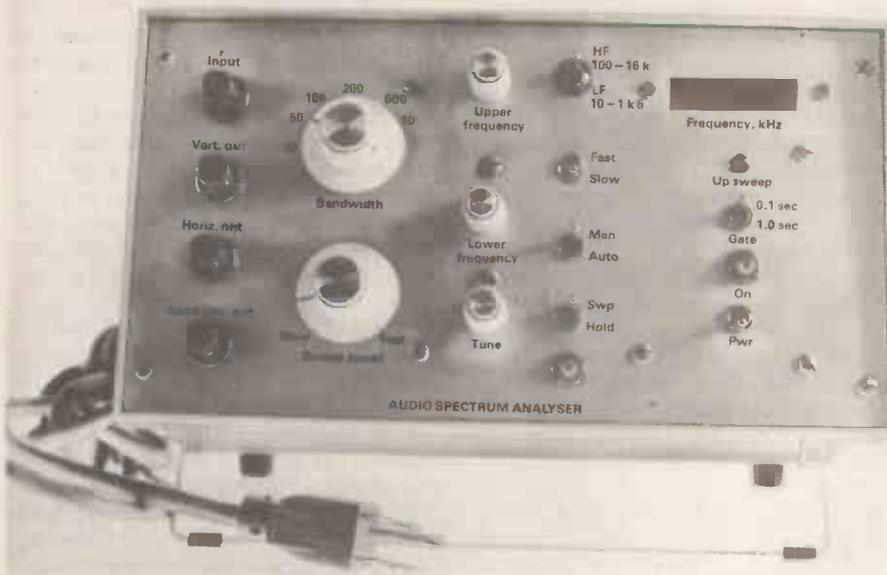
Fig. 7. Prototype analyser.
