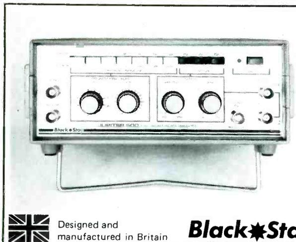
**FUNCTION GENERATOR 0.1Hz - 500kHz**
