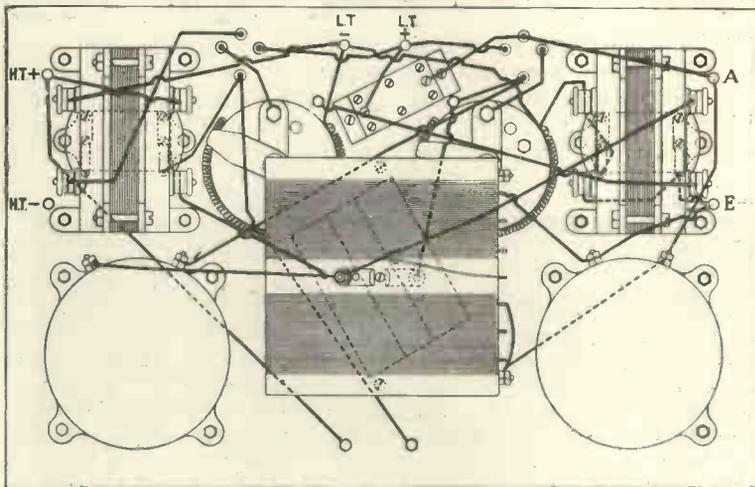
Fig. 3.—The wiring diagram.
