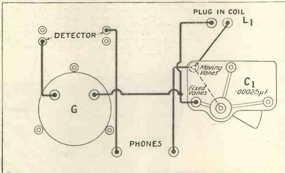
Fig. 5.—Half scale wiring diagram.
