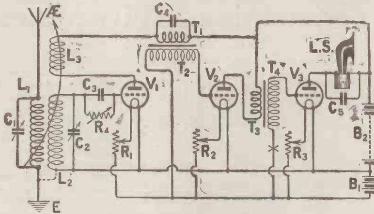
Fig. 1.—The circuit arrangement.
