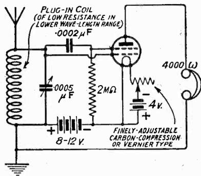
Fig. 1.—The "Negadyne" circuit.
